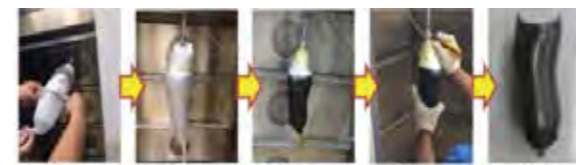
图3 CFRP假肢接受腔的制造流程
